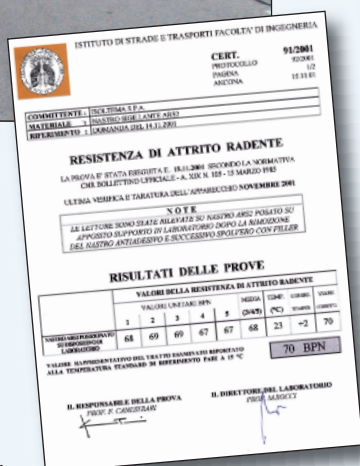
Figura 4 - Il certificato del test di determinazione dell'attrito radente tra nastro il Stratos ARS2 e il traffico
